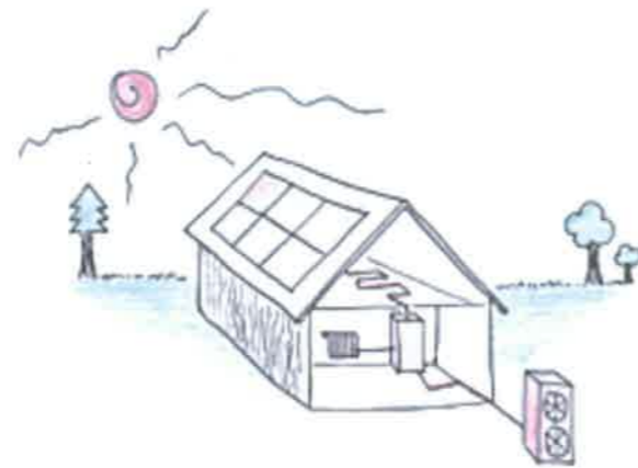
z.B. Luftwärmepumpe und Photovoltaik
