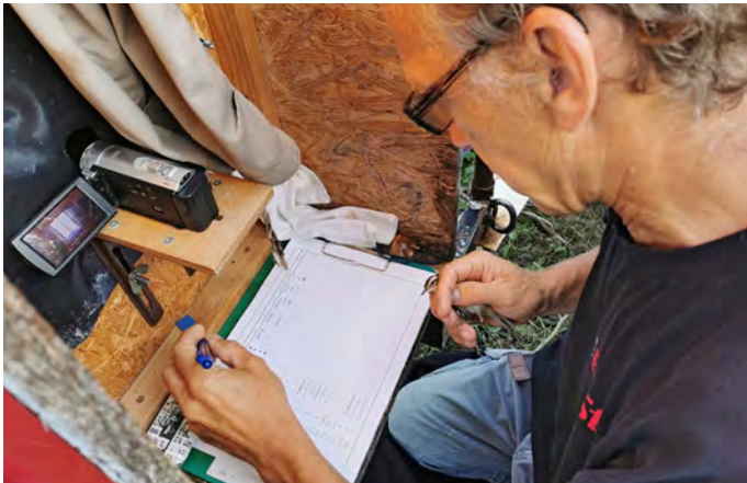
Der Testvogel (rechte Hand) wurde zuvor in einem von 16 speziellen Netzen gefangen und in der Vogelberingungsstation Hohenau-Ringelsdorf beringt, vermessen und registriert. Am Flugtunnel wird nochmals die Ringnummer erfasst. Der ca. drei Sekunden lang dauernde Flug der tageslichtadaptierten Vögel wird auf Video aufgezeichnet. Lichtmessgeräte speichern automatisch die Beleuchtungssituation.
