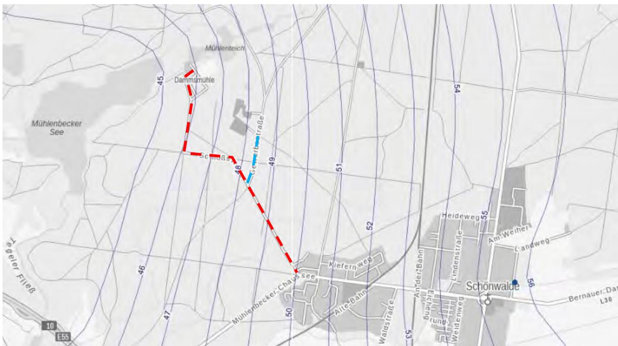
Betrachtet man die Daten naheliegender Grundwassermessstellen, ist mit einem Anstieg des Grundwassers um etwa 1,2 m zu den höchsten Grundwasserständen zu erwarten. Für eine genaue Ableitung des HGW müssen Beobachtungspegel mit laufender Aufzeichnung der Werte über einen längeren Zeitraum installiert
